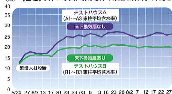
含水率 (%) 《当社テストハウスにおける床下束柱木材含水率比較》
