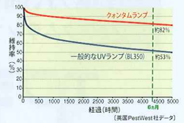
紫外線は人の目には見えません。ランプが青白い光を放って明るく見えていたとしても、紫外線の照射量は時間の経過とともに確実に減少しています。 (英国PestWest社データ)
