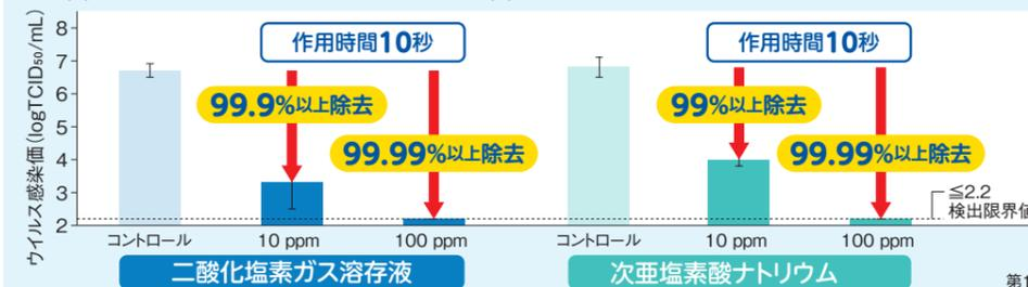
[方法] 新型コロナウイルス (SARS-CoV-2, JPN/TY/WK-521 strain) に各薬剤の所定濃度を所定時間作用させ、そのウイルス感染価を測定しました。コントロールとしてリン酸緩衝生理食塩水を同様の方法でウイルス感染価を測定し、比較しました。
